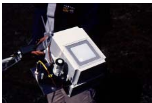
Figur 3.19. Cropscan Multispectral Scanner 16 i vandtæt hus. Det hvide glas indenfor metalrammen er en diffuser, som spreder den indkommende stråling for de opadvendte sensorer. På siden af huset kan ses en sensor for total indkommende kortbølget stråling samt en sensor for overfladetemperatur. Bag huset skimtes vindhastighedsmåleren (Foto: M.P. Tamstorf).
