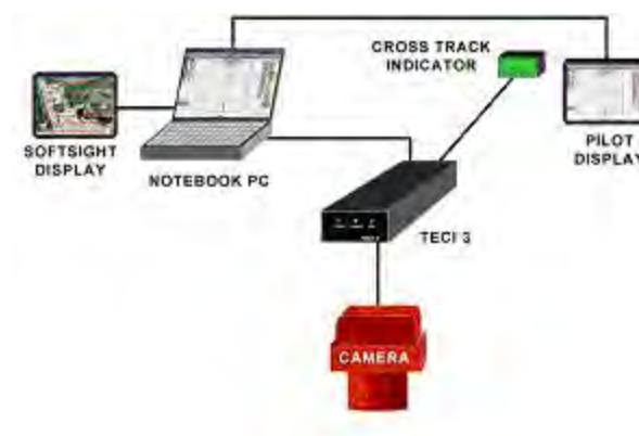
Figur 1. Opsætning af kamerasystem i fly.
