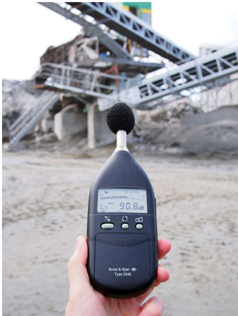
Måling af støj ved Betoncentralen i Nuuk er også en af miljøafdelingens opgaver. Foto: O. Geertz-Hansen
