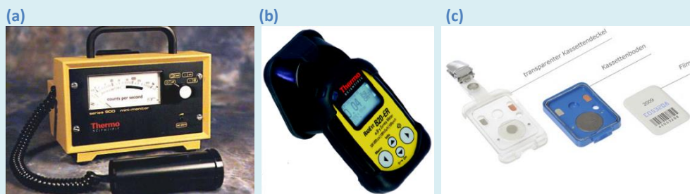
Figur 6. Eksempler på en ældre (a) og en nyere (b) version af en geigertæller til måling af stråling og eksempler på dosimetre (c) til måling af den strålingsdosis, som mennesker udsættes for.
